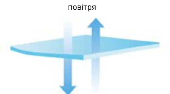
Одношаровий нетканний повітропроникний матеріал (спанбонд)
