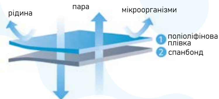
Двошаровий нетканний ламінований матеріал з повітропроникною мембраною (ламінований спанлейс з паропроnikною мембраною)
