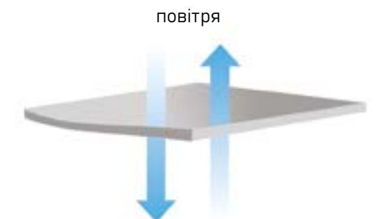
Одношаровий нетканний повітропроникний матеріал (спанлейс)
